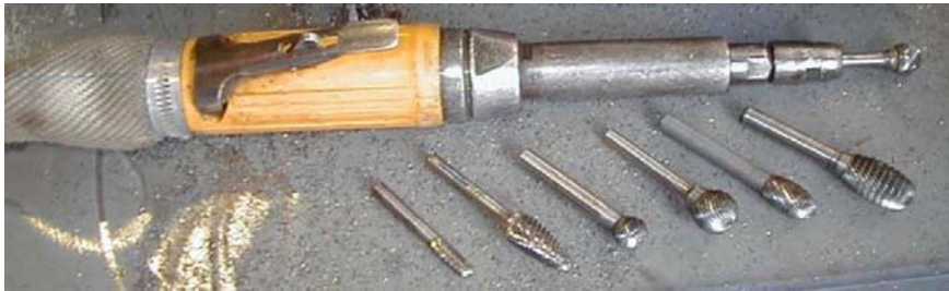
Kuva 7. Pneumaattinen koneviila ja viiloja. [29]
