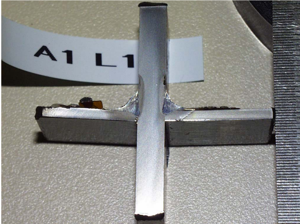
Kuva 2. Esimerkki MIG-juotetusta pienaliitoksesta, jossa perusaine on juuren puolella hieman sulanut ja syntynyt tunkeuma selkeästi nähtävissä. Levyjen paksuudet 2 mm ja 5 mm. Lisäaine CuAl8 ja perusaine S355K2G3. Suoja-kaasuna Argon.
