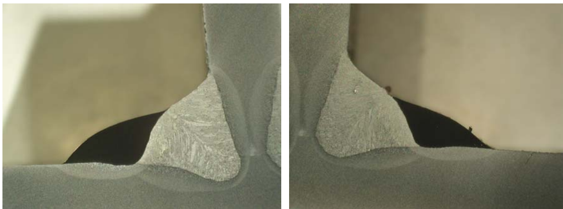
Kuva 36. Liitos, jossa MAG-hitsin rajaviivalle on lisätty MIG-juottamalla ylimääräinen palko. Rajaviivalla ei näy perusaineen sulamista. Hitsin rajaviivalla on sen sijaan sulamista tapahtunut.
