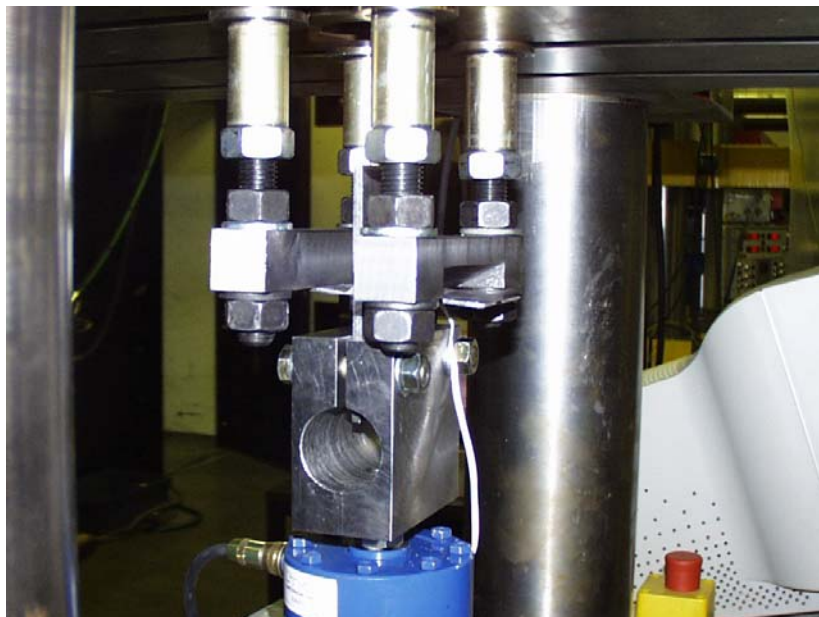
Kuva 17. MIG-juotettujen taivutuskokeiden koejärjestely.
