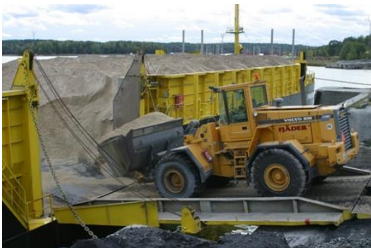
Kuva 26. Bulk -tuotteita (kuvassa hiekkaa) voidaan lastata alukseen kauhakuormaajalla, jos aluksessa on ajoramppi.
