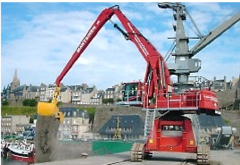
Kuva 29. Telojen päällä liikkuva materiaalinkäsittelykone, nostokyky 6 tn, ulottuvuus 22 m ja kokonaispaino 60 t. /45/
