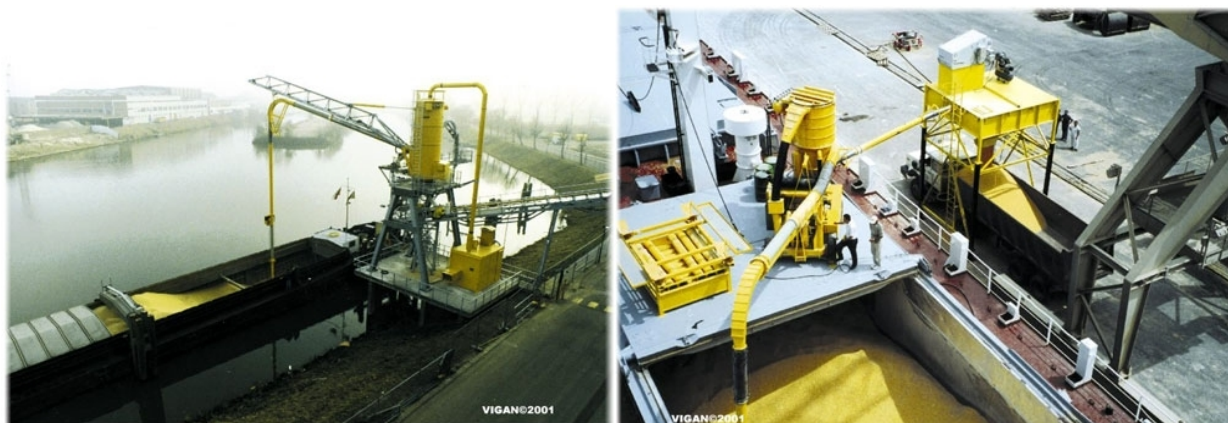
Kuva 30. Pneumaattinen kiinteä purkulaitteisto (vasen). Pneumaattinen purku mobiililaitteella (oikea). /47/
