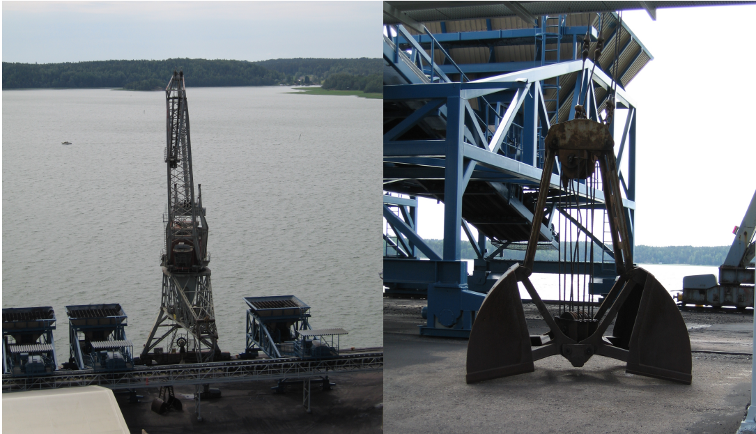
Kuva 31. Kiinteä, kiskoilla liikkuva satamanosturi (vasen) ja kahmarikauha (oikea). /48/
