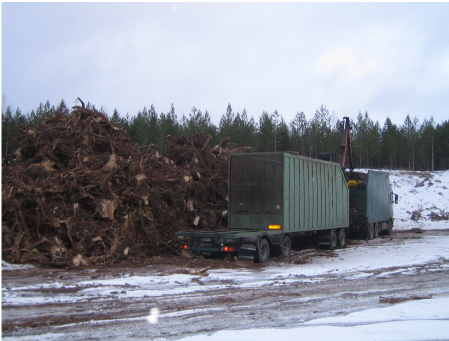
Kuva 4. Perävaunun liukuva sisälava mahdollistaa suuremman kuljetuskertymän ja helpottaa lastausta ja purkua /15/.
