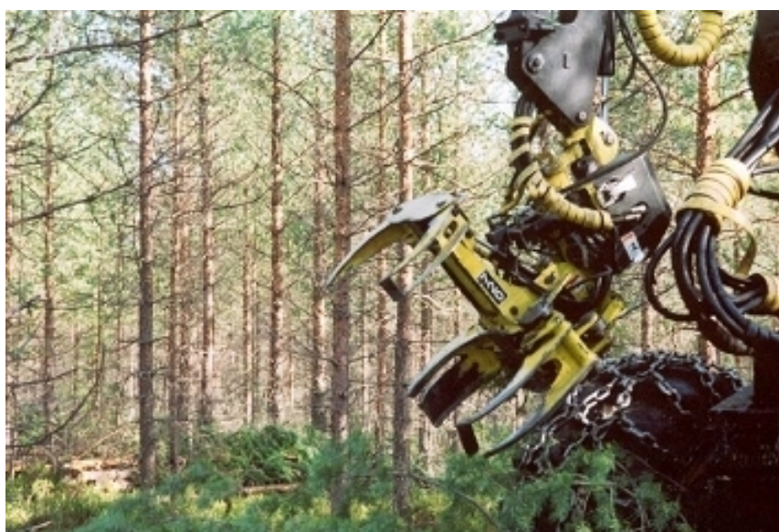
Kuva 18. Timberjack 720 keräävä energiapuukoura nuoren männikön harvennuksella /35/.
