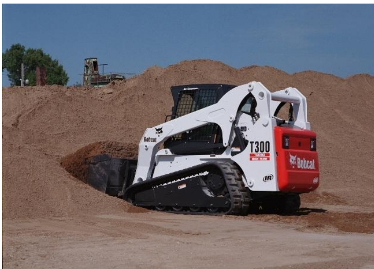
Kuva 25. Hakelastia voidaan tarvittaessa tiivistää ajamalla sen päällä esim. bobcatilla.
