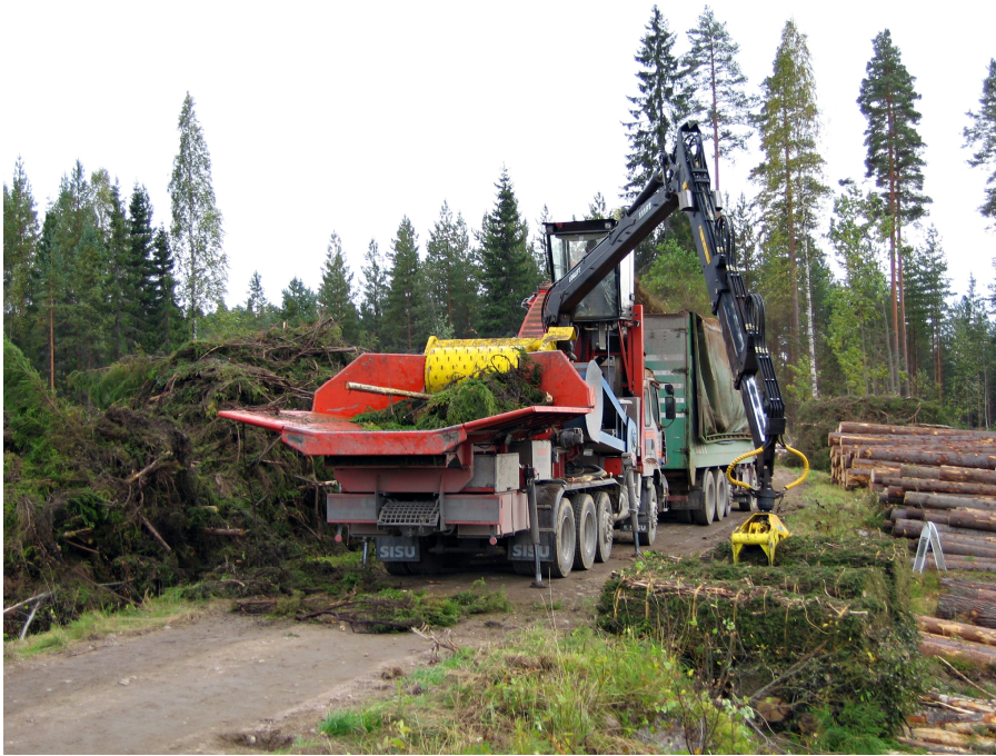
Kuva 15. Kuorma-auton alustalle asennettu Giant -rumpuhakkuri hakettamassa suoraan autoon. /30/
