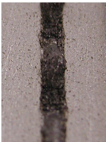
Kuva 37. Lisäaine Inconel 625. Teho 2000 W, jauheensyöttö 29,5 g/min.
