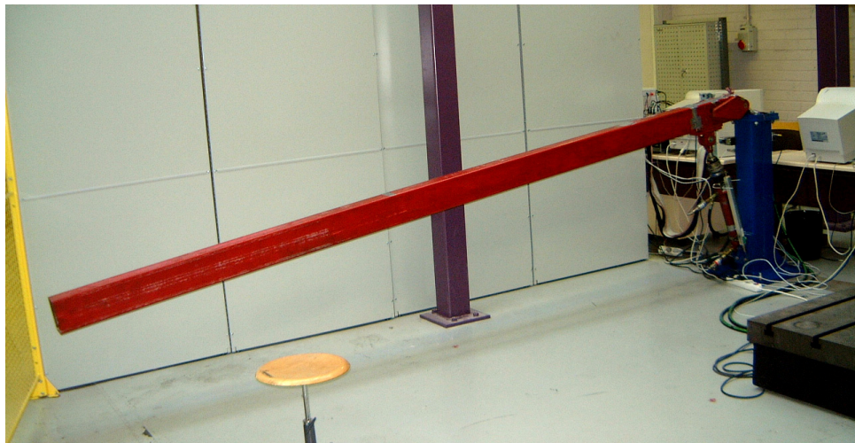
Kuva 8. Tarkasteltava hydraulikäyttöinen puomi.
