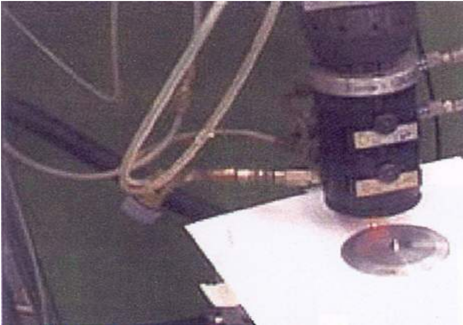
Kuva 40. Jooren ja Hüsslagen työssä käytetty leikkauspää ja leikattavan kartongin asettelu./40/
