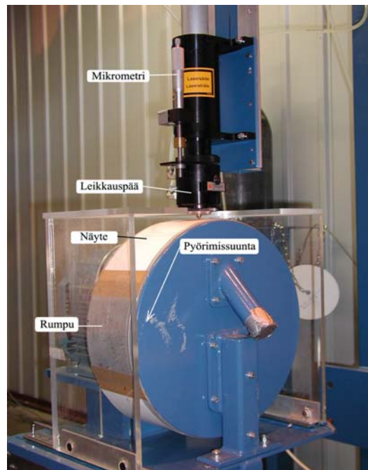
Kuva 62. Ohuiden materiaalien leikkaamiseen käytetty rumpuasema.
