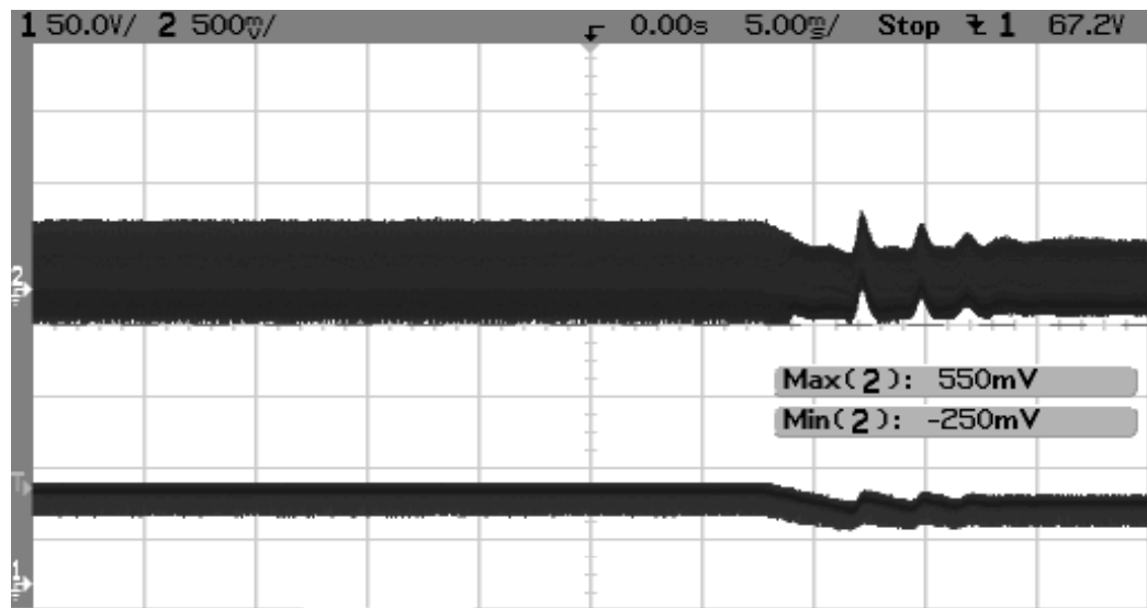
Kuva 42. Tulojännitteen muutos 65 V:sta 55 V:in epäjatkuvalle käännavirralla kuorman ollessa 11 \Omega . Ylempänä nähdään lähtöjännite ja alempana tulojännite.
