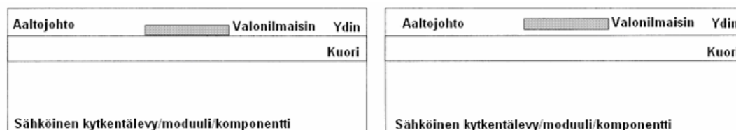
Kuva 19. Aaltojohdon sisälle haudattu valonilmaisimien on tässä tapauksessa sijoitettu aaltojohdon ytimeen.
