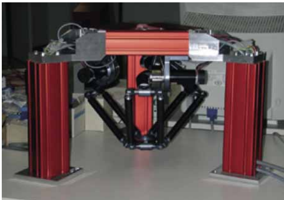
Kuva 24. Microdeltan valmistama prototyyppi mikropallolinssien asettelua ja liimausta varten.
