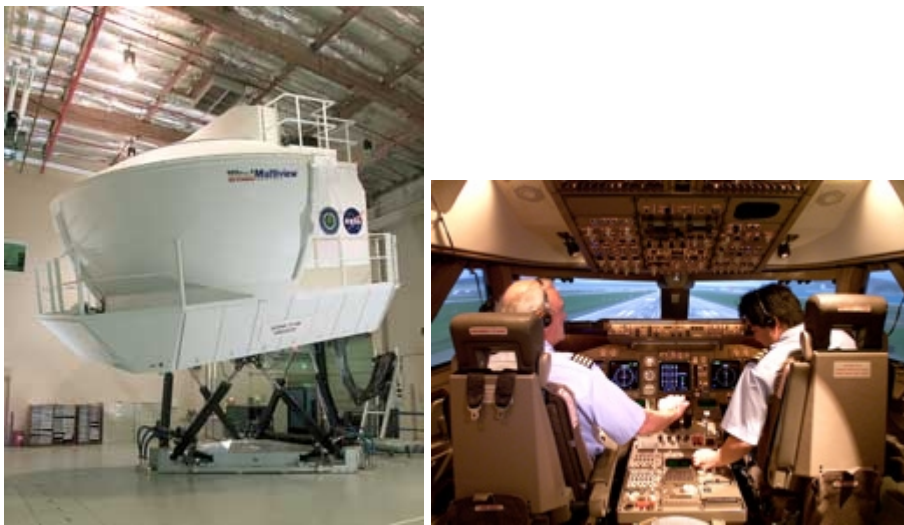
Kuva 2.1 Boeing 747–400 lentokonesimulaattorin rakenne ja ohjaamo. [1]
