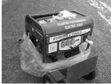
Kuva 14. Pienikokoinen 5,5 hevosvoiman aggregaattilaite.
