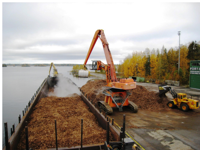
Kuva 12. Telojen päällä liikkuva materiaalinkäsittelykone metsähakkeen lastauksessa proomuun Puhoksen satamassa (kauhakuormaaja apuna) (Tomi Vartiamäki, Koneyrittäjien liitto ry.)
