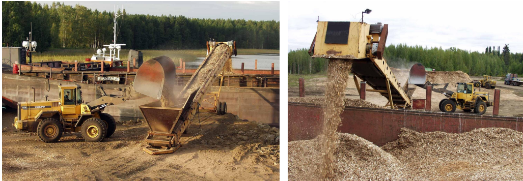
Kuvat 11. Hihnakuuljettimen käyttöä lastauksessa ESE Oy:n kuljetuskokeilussa (NK Consult, St. Petersburg)
