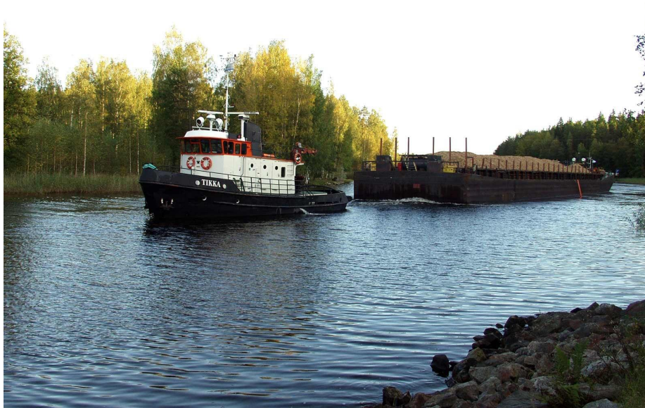
Kuva 10. Pienen hinaajan, apualuksen ja suurproomun (Eurooppa IIa) muodostama kytkeyde soveltuu myös syväykseltään matalammille ja ahtaammille väylille (NK Consult, St. Petersburg).
