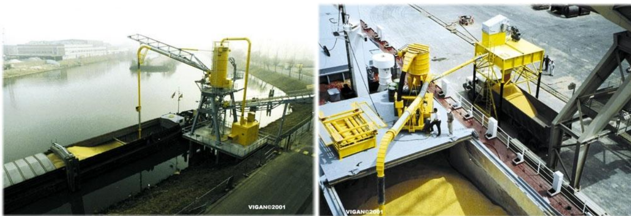
Kuvat 13. Pneumaattinen kiinteä purkulaitteisto (vasen). Pneumaattinen purku mobiililaitteella (oikea). (Vigan)
