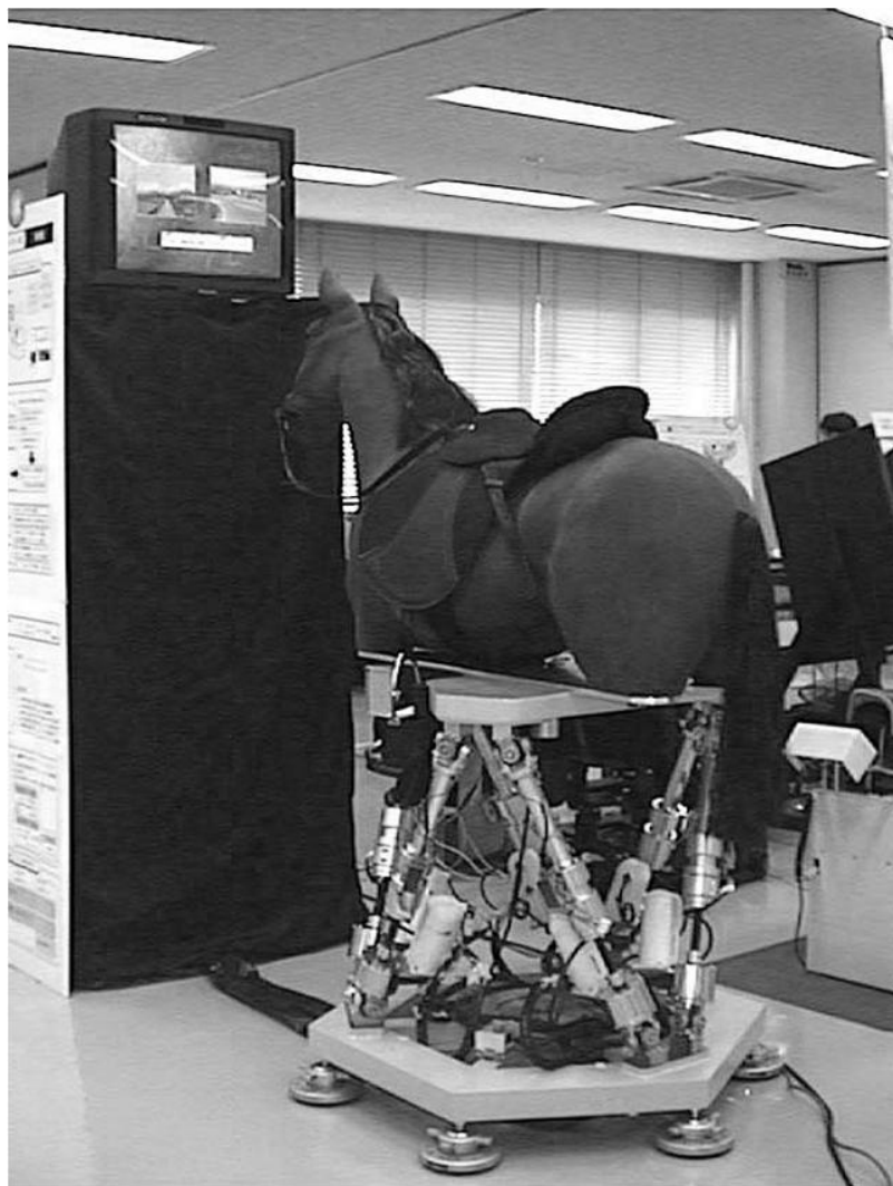
Kuva 5. Tyypillinen tutkimuksissa käytetyn ratsastussimulaattorin rakenne [9].
