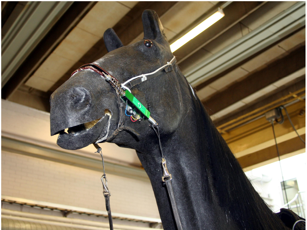
Kuva 21. Suitsiohjeet toteutettiin lineaaripotentimetrillä.
