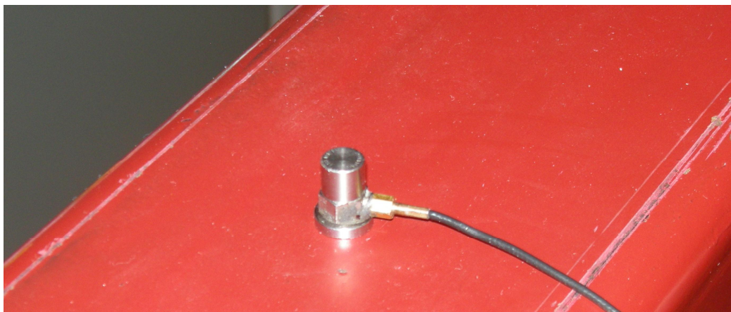
Kuva 4.4. Piezosähköinen kiihtyvyyssanturi kiinnitettynä puomiin.
