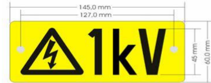
Kuva 5.4. Katkaisijakaapin, erotuskytkimen ja muuntamon merkintäkilpi (YJ 7:06).
