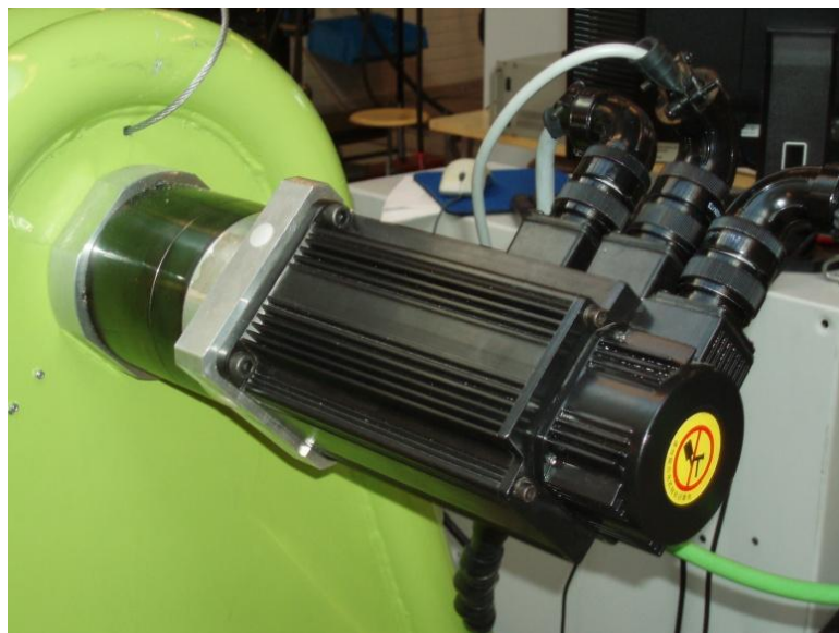
Kuva 4.16 X-akselin servomoottori ja vaihde asennettuina liikealustaan
