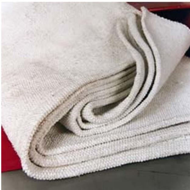
KUVA 5. Asbestipalohuopa (HSE 2009a)
