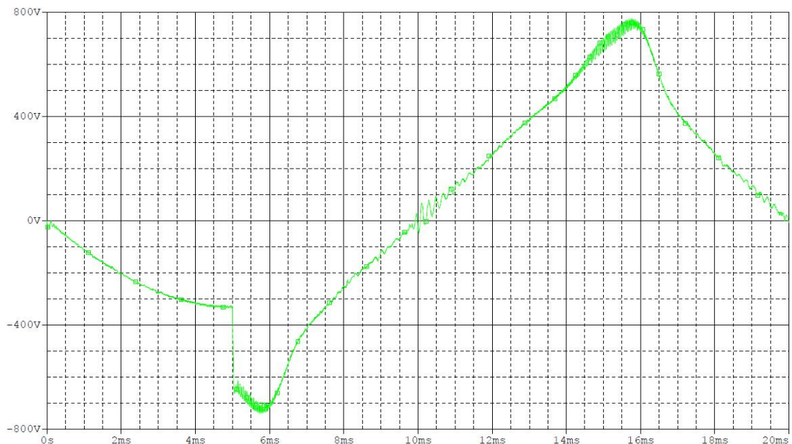
Kuva 5.21. Säättämättömän lähdön jännite, kun täydestä kuormasta poistetaan 99 % 5 ms kohdalla.
