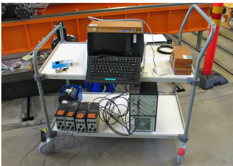
Kuva 1.1. Lappeenrannan teknillisen yliopiston moodianalyysilaitteisto.
