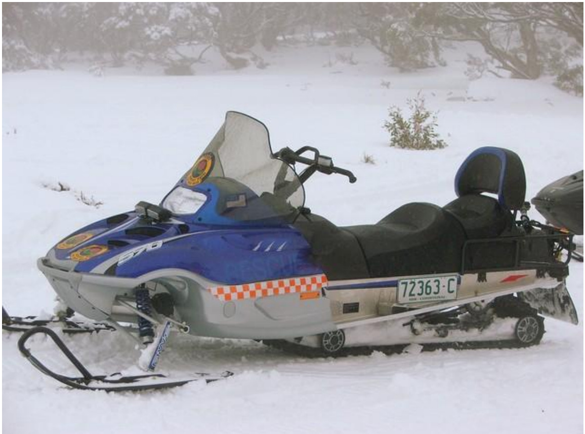
Kuva 1.1 Moottorikelkka. Kuvassa näkyvät kelkan hallintalaitteet, ohjauksjärjestelmä sekä kelkan alla oleva vetotela. Kelkassa on kaksi istumapaikkaa. /2/
