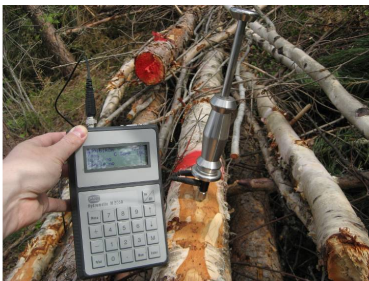
Kuva 1. Kosteuspitoisuuden mittaaminen piikkikosteusmittarilla hakkuukasasta palstalla.
