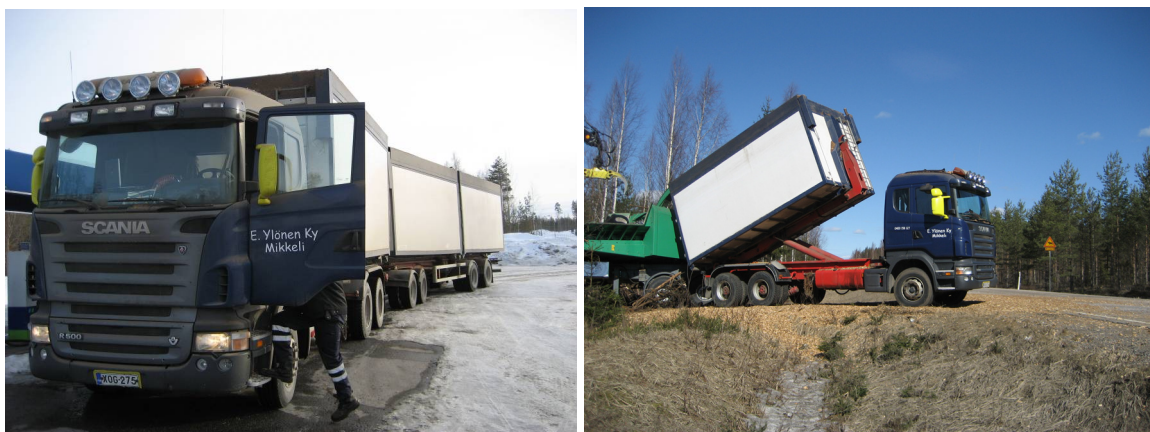
Kuvat 2 ja 3. Siirtokonttihakerekkä oli varustettu koukkulavalaiteistolla.
