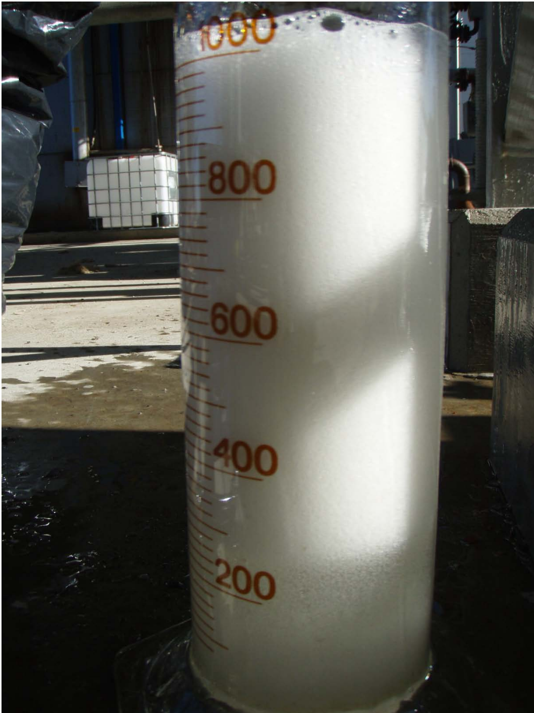
Kuva 11 Selkeytymiskoe 30.9.2010 lämmönvaihtimella E702, 1. mittaus, jäähdytysnesteen tila ennen tyhjiökaasunpoistimen käynnistämistä.
