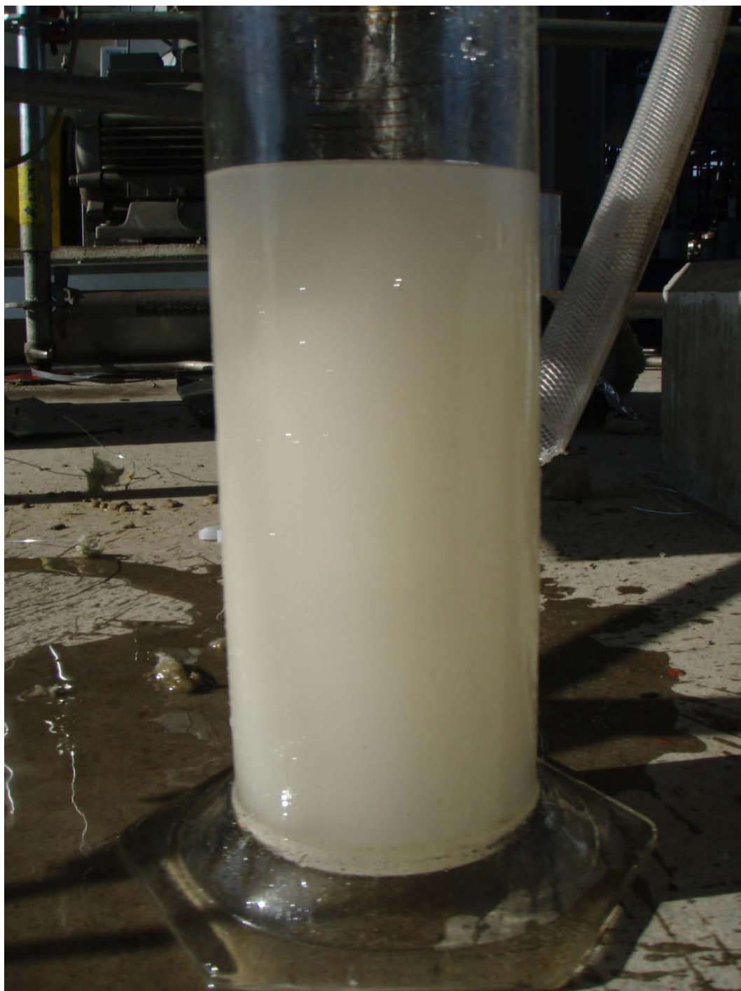
Kuva 12 Selkeytymiskoe 4.10.2010 2010 lämmönvaihtimella E702, 3. mittaus, jäähdytysnesteen tila 4 päivää tyhjiökaasunpoistimen käynnistämistä.
