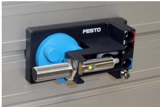
Kuva 2.6. Feston optinen anturi (lähetin-vastaanotin -periaate).
