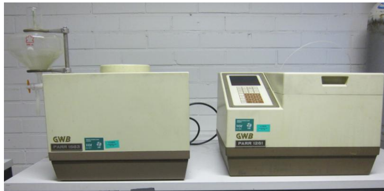
Kuva 37. Parr 1563 -vedenkäsittelylaitteisto (vas.) ja Parr 1261 -kalorimetri
