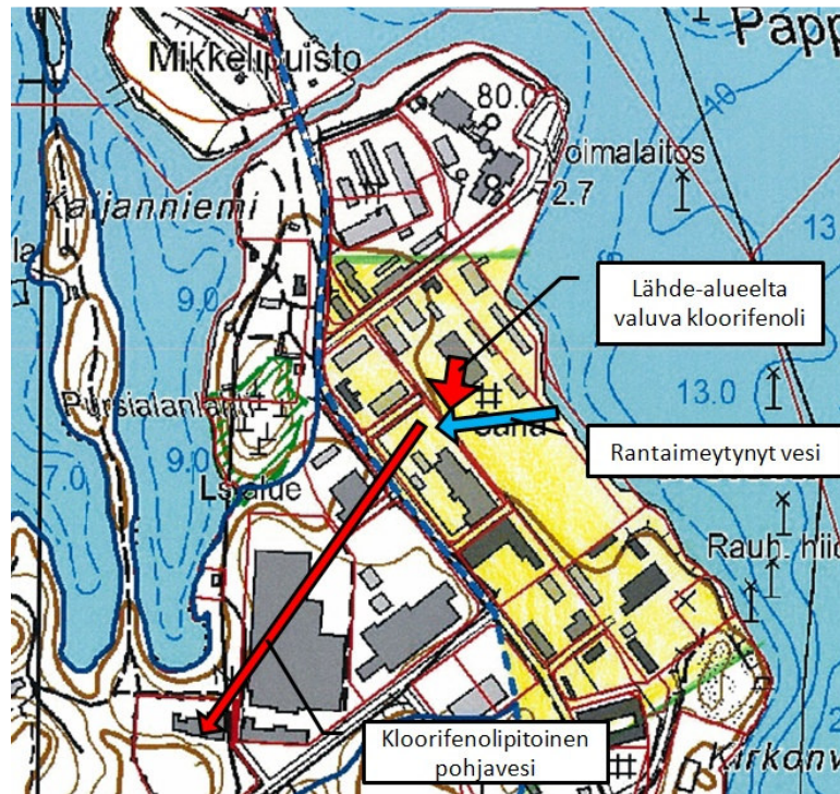
Kuva 12. Pappilanselästä rantaimetyvän veden kulkureitti.
