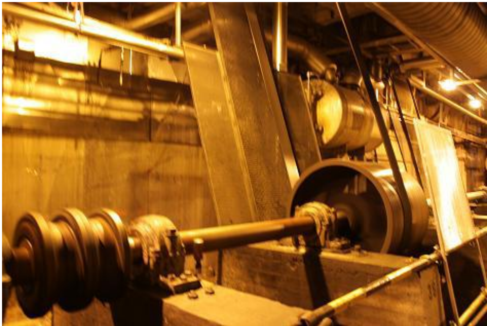
Kuva 1.1 Imatran paperitehtaan kartonkikoneen 1 eräs kuivausryhmän valta-akseli. Kuvassa näkyy hihna, jonka välityksellä moottori pyörittää akselia, kytkin ja muutama kannatinlaakeri. (Hartikainen 2011)
