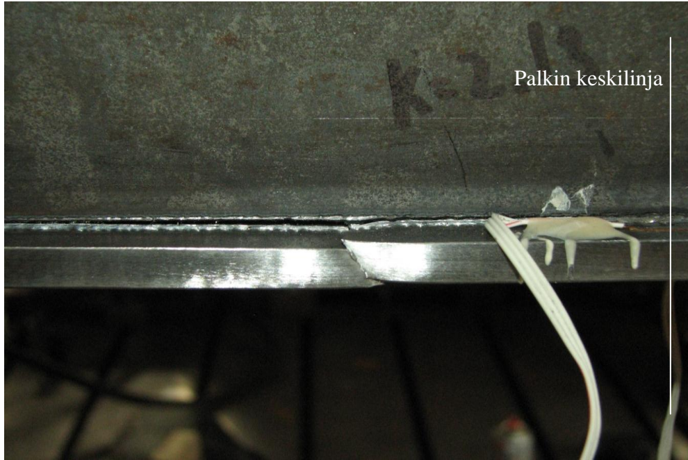
Kuva 19. Koekappaleeseen FF5 syntyneen särön eteneminen alalaipan läpi
