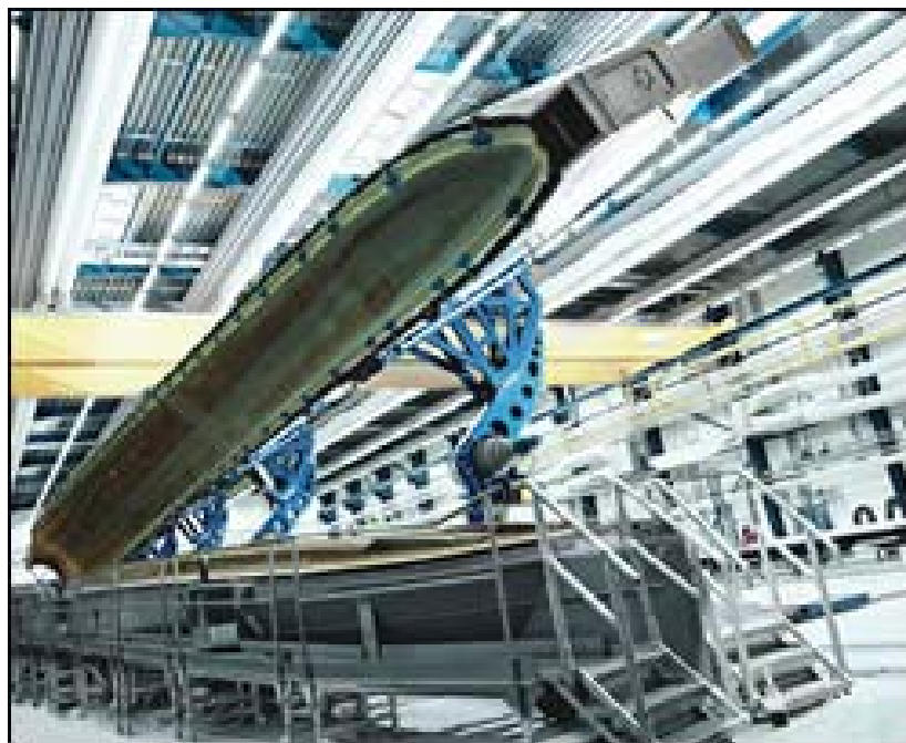
Kuva 8. Tuuliturbiinin lavan valmistus /16/.
