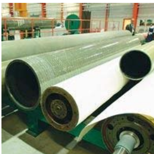
Kuva 4. Metso Compositesin valmistamia hiilikuituisia komposiittiteloja /6/.
