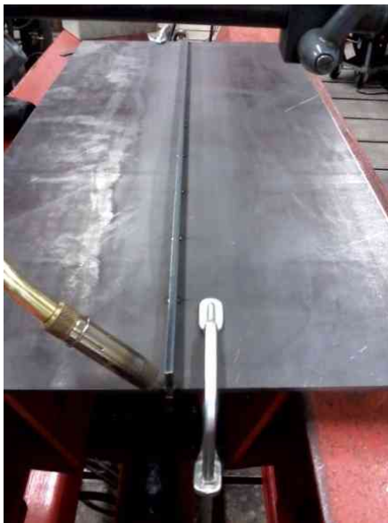
Kuva 2. Mekanisoidun hitsauksen kojärjestelyt LUT:n hitsaustekniikan laboratoriossa.
