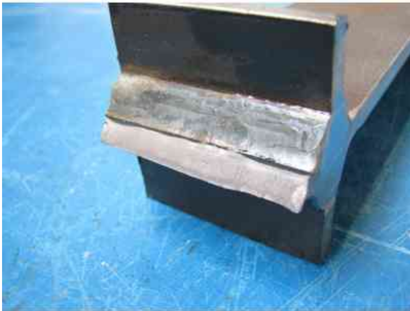
Kuva 16. Timo Björkin ULTRASTEEL-hankkeen tuloksia. Suurilla R -arvoilla murtopinta lähenee 45 asteen kulmaa. [2]
