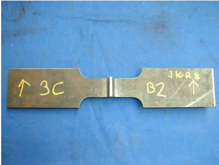
Kuva 4. Koesauva JK_R8 odottamassa jälkikäsittelyä (TIG).
