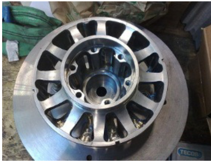
Fig. 4.13. Rotor shaft of the EM machine.
