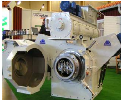
Kuva 11. Puristin, jossa pyörivä rengasmatriisi (Granö 2006, 1)
