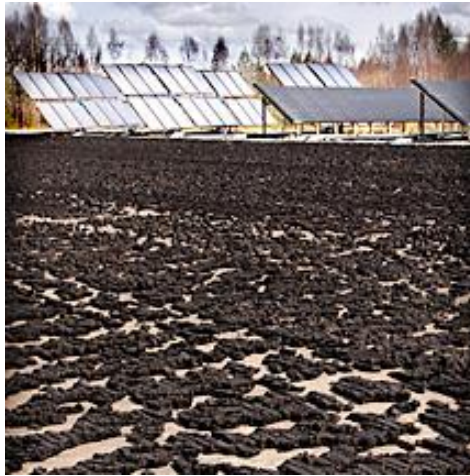
Kuva 45. Turpeen kenttäkuivaus aurinkopaneelien avulla (Vapo)
