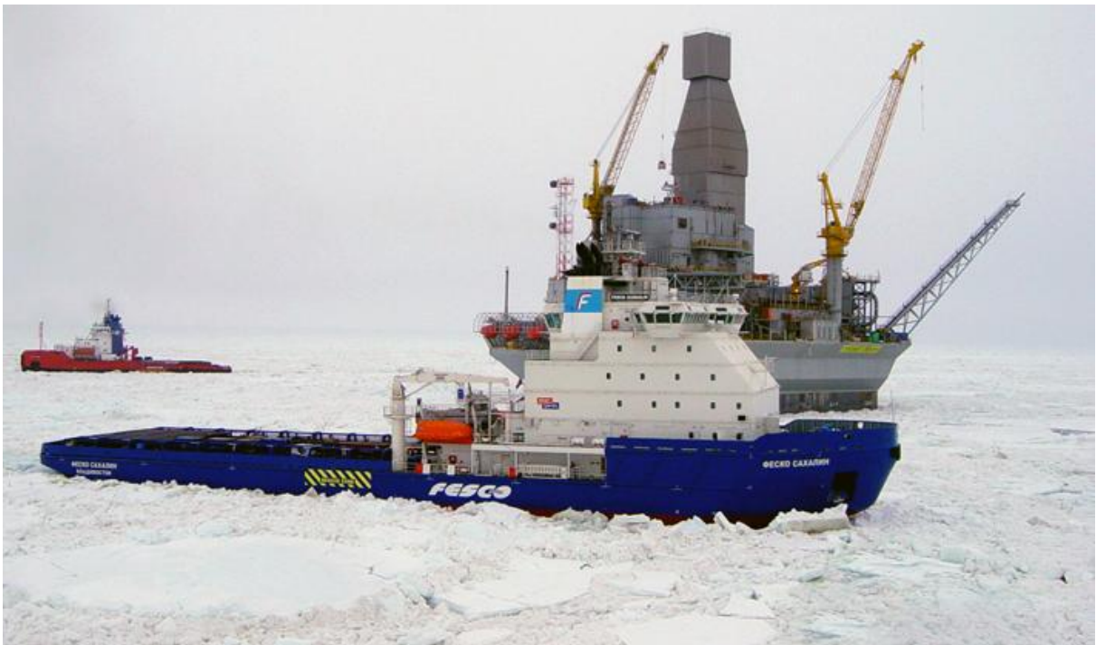
Kuva 37. Sakhalinin kentälle toimitettu Fesco Sakhalin jäätä murtava huoltoalus (Aker Arctic)
