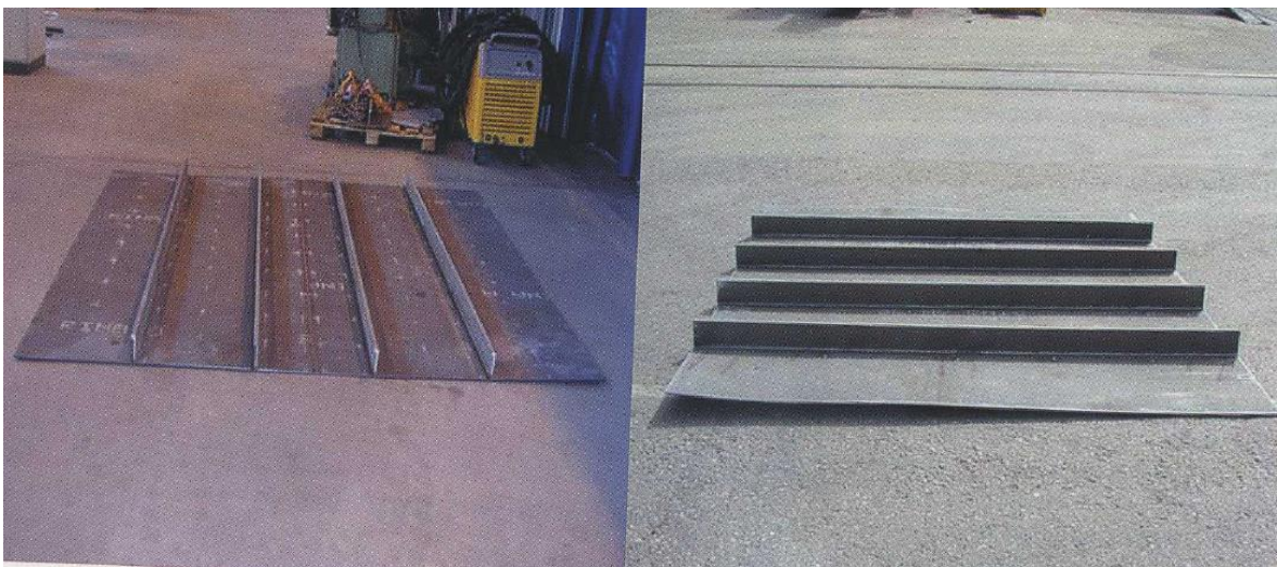
Kuva 9. Vasemmalla hybridihitsattu laivan kansirakenne ja oikealla kaarihitsattu kansirakenne (Jernström et al., 2002, s. 40)
