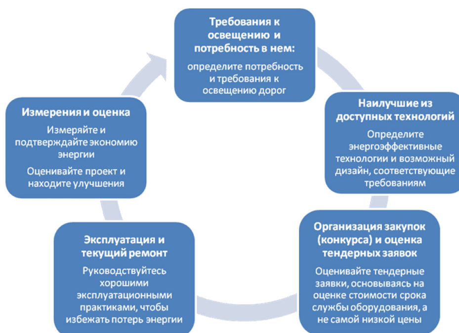
Рисунок 4.1: Типовые этапы повышения энергоэффективности уличного освещения [USAID, 2010].
