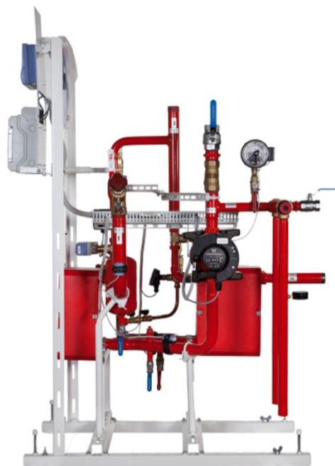
Рис. 3.3: Узел системы централизованного теплоснабжения фирмы «Gebwell's G-Power unit», применяемый для отделения внутрисетевой сети от муниципальной и регулирования подаваемого тепла [Gebwell, 2012].
