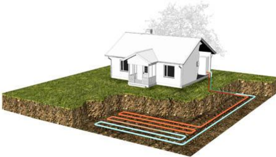
Kuva 9. Maaperään asennettu keruuputkisto (Geoenergia.fi 2010).
