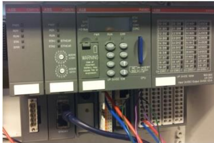
Kuva 2.4 AC500-logiikka, Ethercat-, CAN- ja DA501-moduulit (Loppuraportti 2013).
