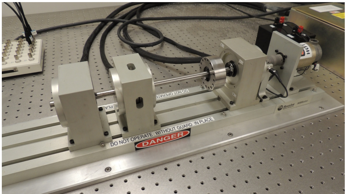
Figure 1. Multipurpose reconfigurable AMB test rig [1]
