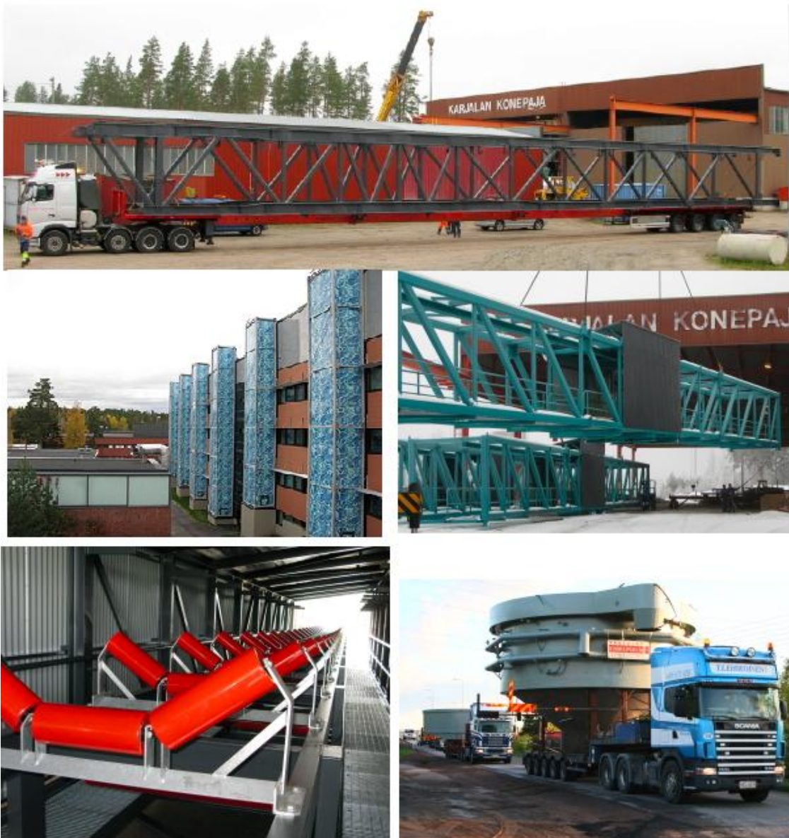
Kuva 19. Karjalan Konepaja Oy:n valmistamia tuotteita. Kuvassa ylhäällä on erikoiskuljetin, keskellä vasemmalla tekniikkatorni, keskellä oikealla putkisilta, alhaalla vasemmalla kuljetin ja alhaalla oikealla rakeistusallas. (Karjalan Konepaja Oy, 2014.)
