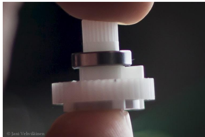
Kuva 9: Servomoottorin liikettä rajoittava mekaanen pala
