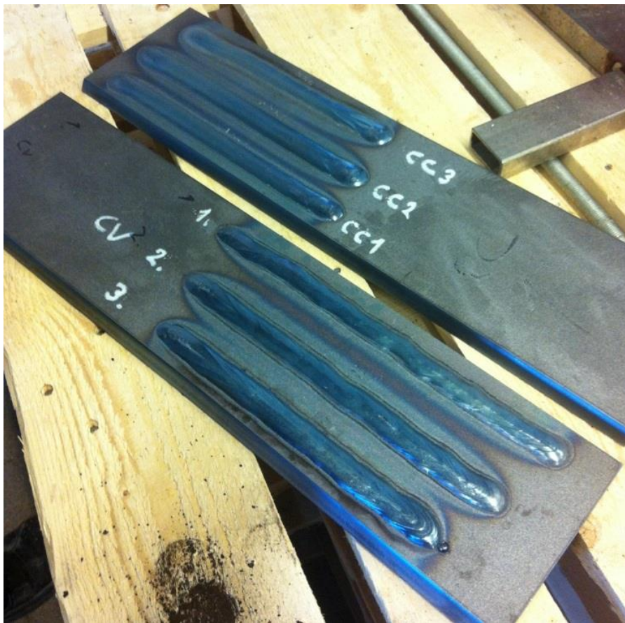
Kuva 19. Yleiskuva koehitseistä, jossa CV tarkoittaa vakiojännitteellä hitsattuja koehitsejä ja CC vakiovirralla hitsattuja koehitsejä.
