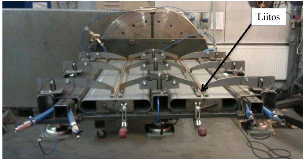
Kuva 32. Laivaportaiden askelmien hitsauskiinnitin. (Koneteknologiakeskus Turku Oy, 2014)
