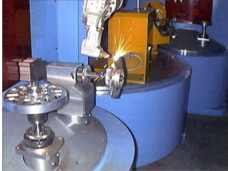
Kuva 29. Siipipyörän laserhitsaus. (Appendino, 2014, s. 194)
