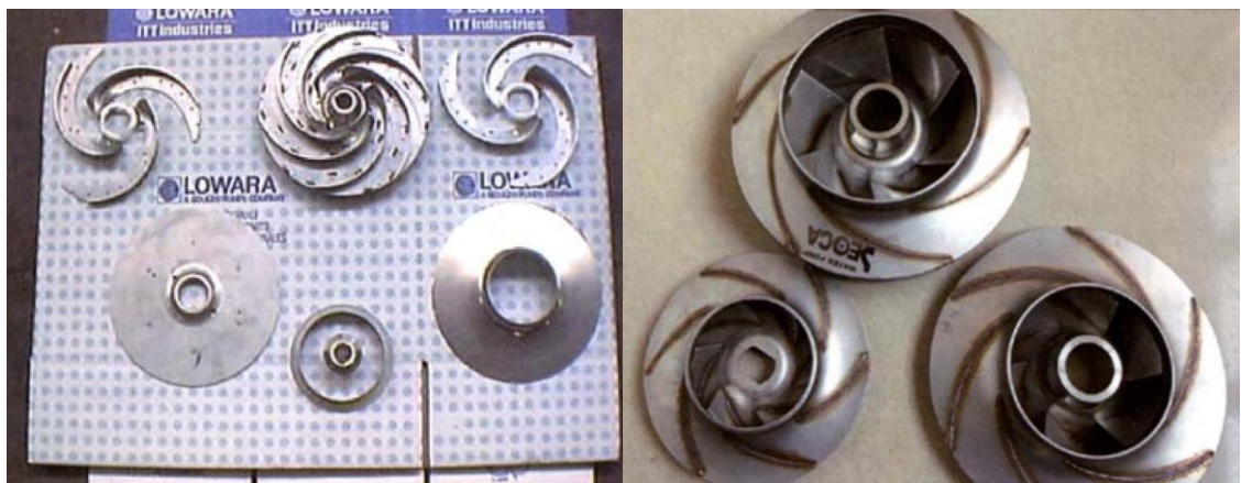
Kuva 28. Laserhitsatun siipipyörän osat sekä valmiita hitsattuja siipipyöriä. (Appendino, 2014, s. 194)
