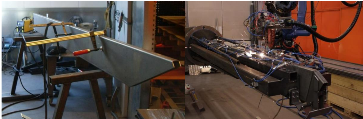
Kuva 31. Hitsaamaton laivaportaatan reiden kokoonpano, sekä reiden hitsaus hitsaussolussa. (Koneteknologiakeskus Turku Oy, 2014)
