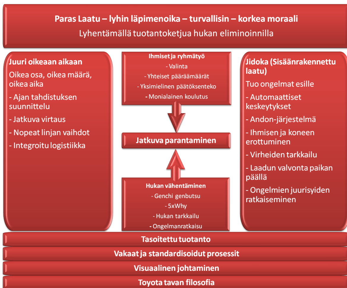
Kuva 2. Toyotan tuotantojärjestelmä (mukaillen Liker, 2010, s. 33).
