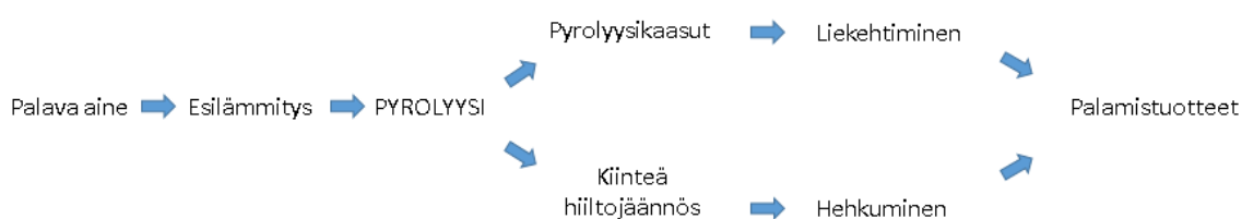
Kuva 3. Pyrolyysiprosessin yksinkertaistettu malli.
