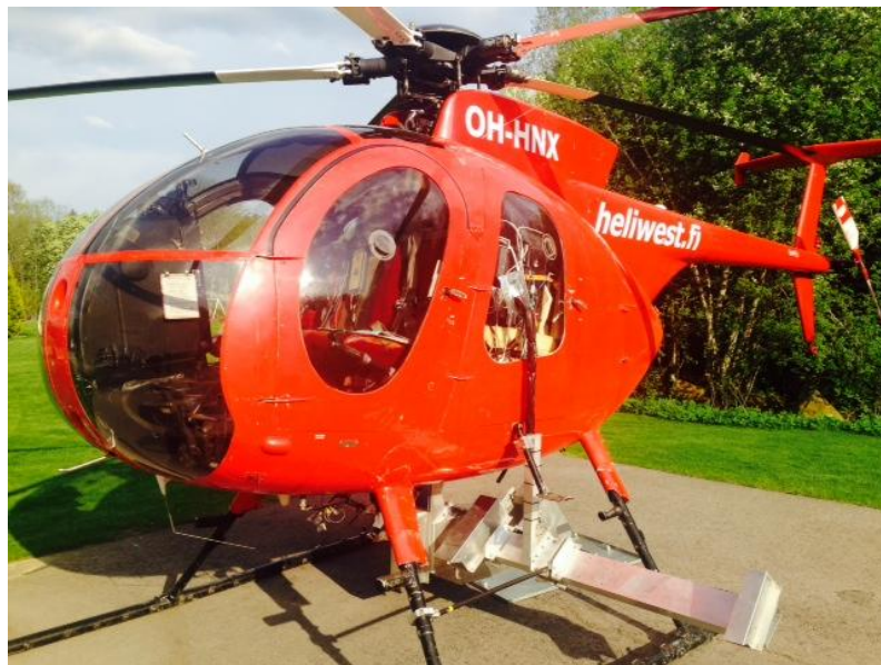
Kuva 3.1 Elenian ilmajohtojen laserkeilauksessa ja 3D-kuvauksessa vuonna 2014 käyttämä helikopteri tarvittavine laitteistoineen. (Elenia 2014)
