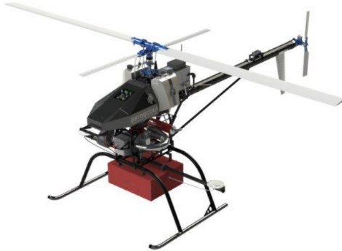
Kuva 2.3 Laserkeilauslaitteistolla varustettu miehittämätön kauko-ohjattava lennokka (UAS 2014)
