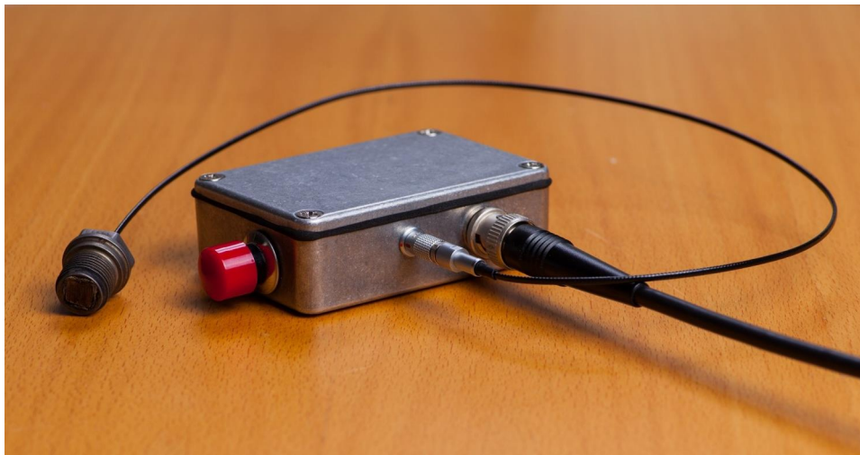
Kuva 4.4. Lopullinen laite. Metallinen ulkokuori ja liittimet suojaavat mittauselektroniikkaa kytkeytyviltä häiriöiltä.
