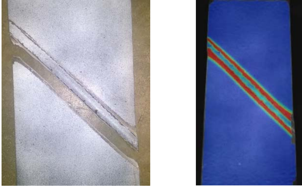
Kuva 18. Murtumisen sijainti sekä ARAMIS jännityskuvaaja hieman ennen murtumista, kun kulma on 45°.
