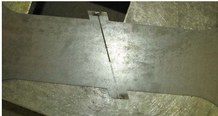
Kuva 7. Koekappaleen aloitus ja lopetus ulokkeet, joihin on hitsattu silloitus hitsit.
