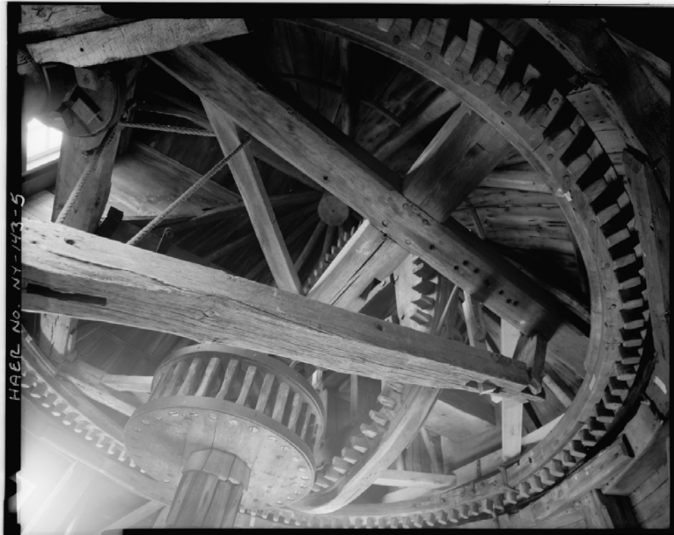
Kuva 1. Primitiivisiä hammaspyöriä Pantigon tuulimyllystä (Historic American Buildings Survey).
