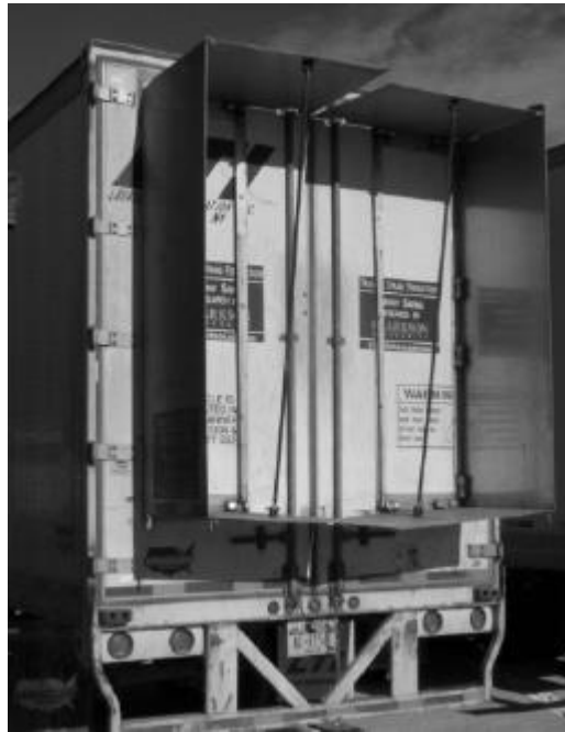
Kuva 11. Sisennetty boat-tail-perä suorilla läpillä (Coon & Visser, 2004 s. 263).
