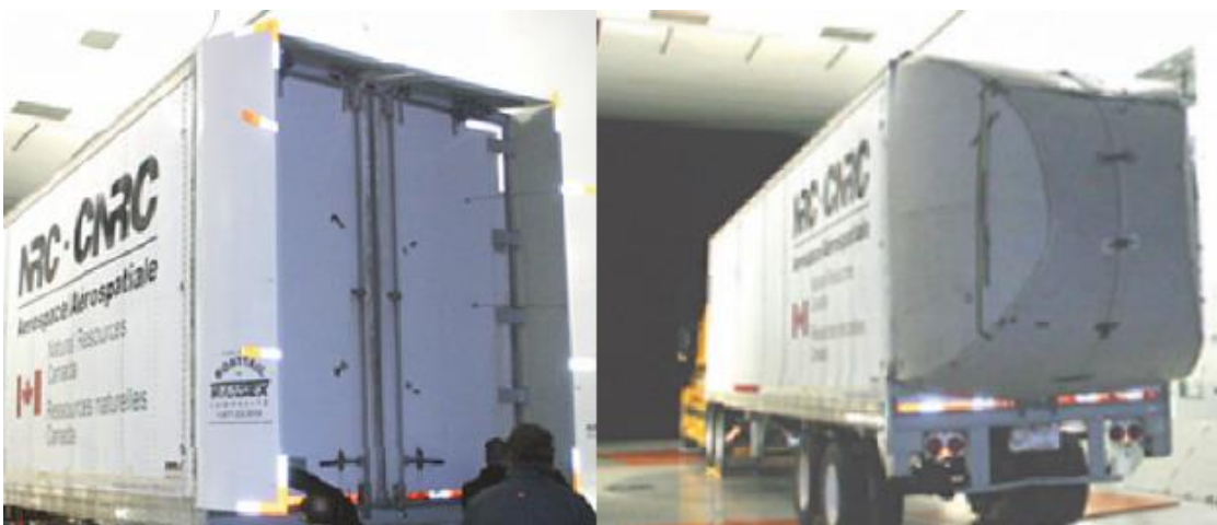
Kuva 6. Vasemmalla Transtexin taittuva perän komposiitti-ilmanohjain ja oikealla Aerovolutionin ilmalla täytettävä boat-tail-perä (Leuschen & Cooper, 2009, s. 459).
