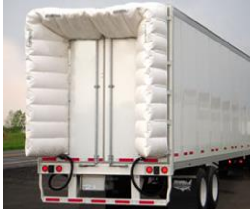
Kuva 7. Ilmalla täytettävä avonainen boat-tail (Aerodynamic Trailer Systems, 2015).
