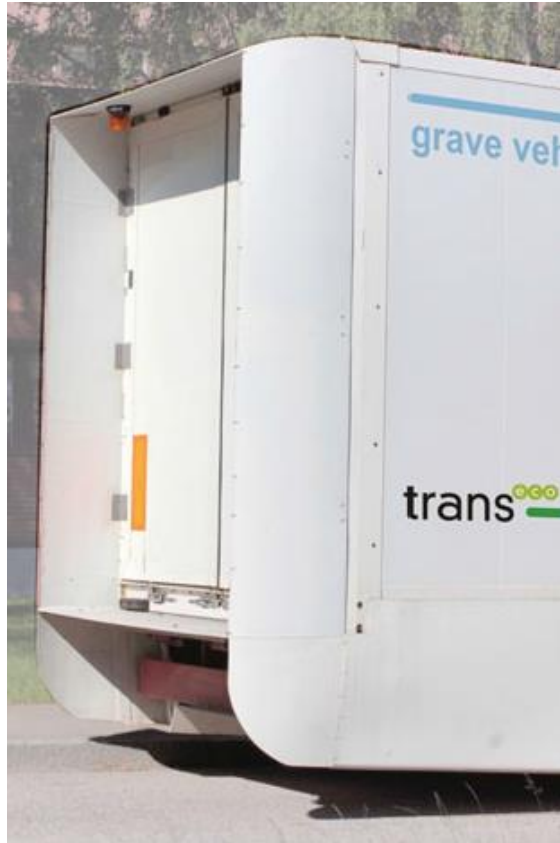
Kuva 8. VTT:n tutkiman aerodynamiikkaosasarjan peräosa (Laurikko et. al., 2012, s. 62).
