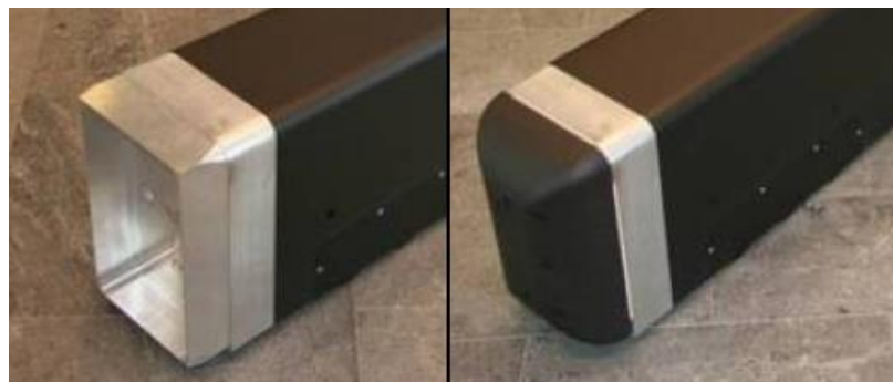
Kuva 13. VTT:n tutkimuksissa käytetyt pienoismallit, joissa pieni boat-tail sekä peräpuhallus (Sainio et al., 2010, s. 8).
