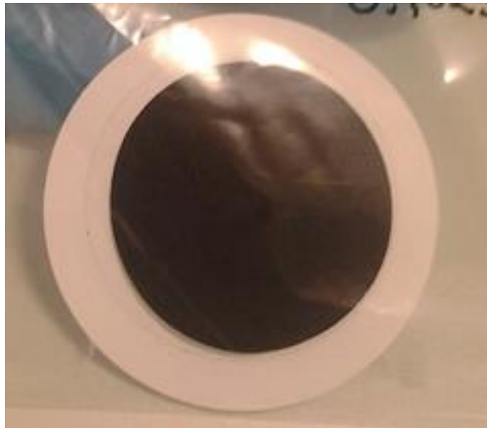
Kuva 8. Valmis elektrodiarkki, jonka taustalla membraanisuodatin
