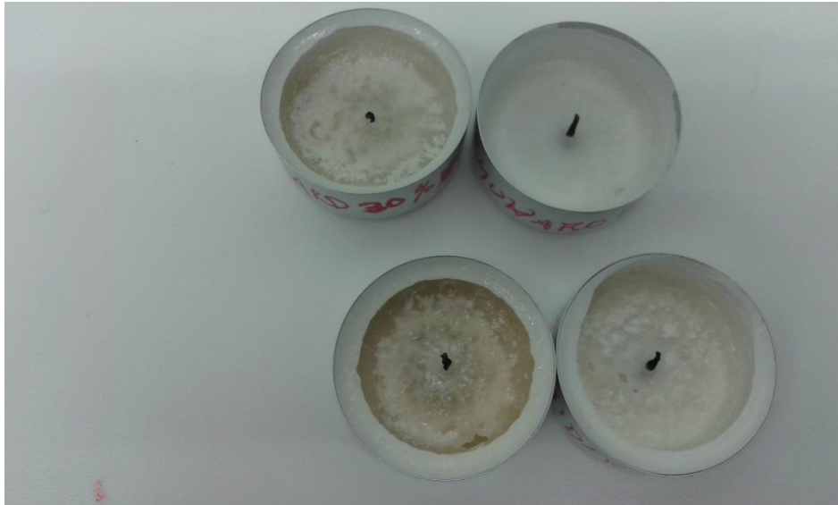
Kuva 3 Lämpökaapissa kauan seisonut steariini ei enää toiminut kynttilän raaka-aineena.
