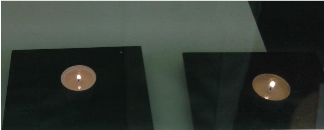
Kuva 1 Vasemmalla raaka-ainetta kertynyt reunoille, oikealla raaka-aine sulanut.
