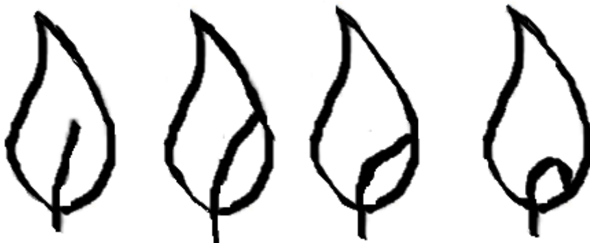
Kuva 7 RAL-laatustandardin määritelmä oikealle sydänlangan asennolle lämpökynttilässä. Ensimmäisessä kuvassa vasemmalta lanka on liian suorassa, toisessa kuvassa ideaalinen, kolmannessa hyvä ja neljännessä liian kaareva. Mukailtu alkuperäisestä (RAL, 2014).
