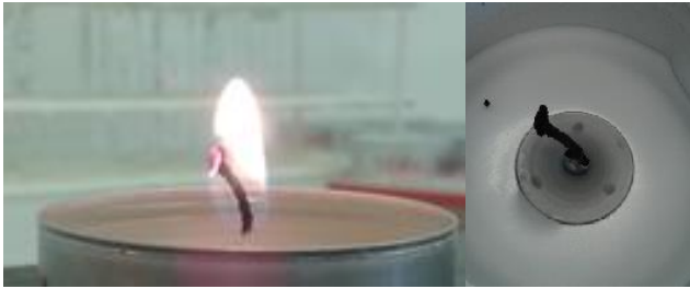
Kuva 8 Lämpökynttilän palamisen aikana sydänlangassa esiintyvä hiilimuodostuma eli nk. sieni. Sieniä ei saisi esiintyä polton aikana.
