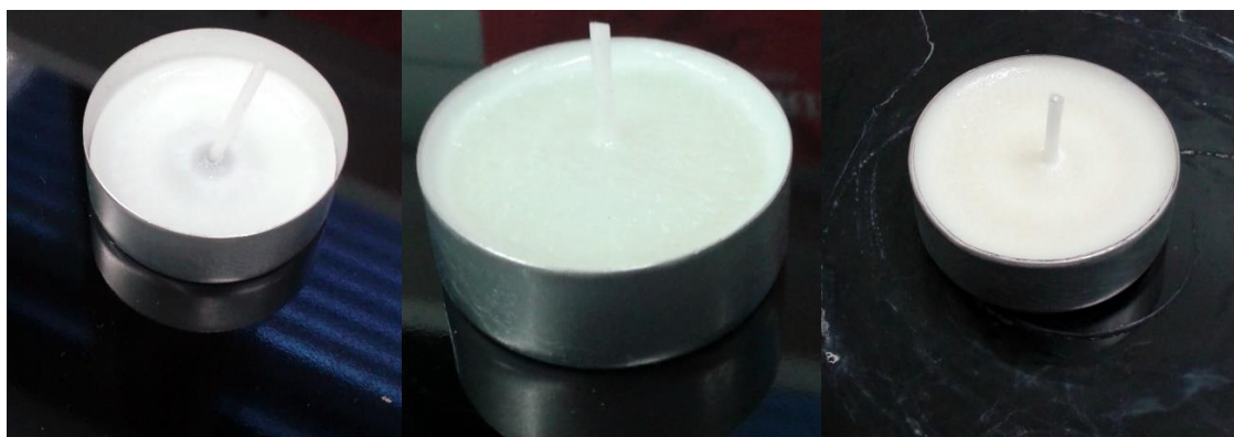
Kuva 9 Ensimmäisen erän valu, jäähtymässä oleva ja valmis jäähtynyt kynttilä.
