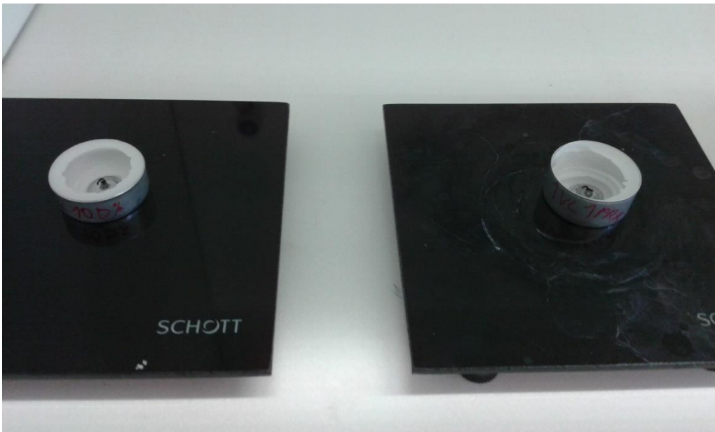
Kuva 2 Palamatonta raaka-ainetta lämpökynttilän reunoilla.
