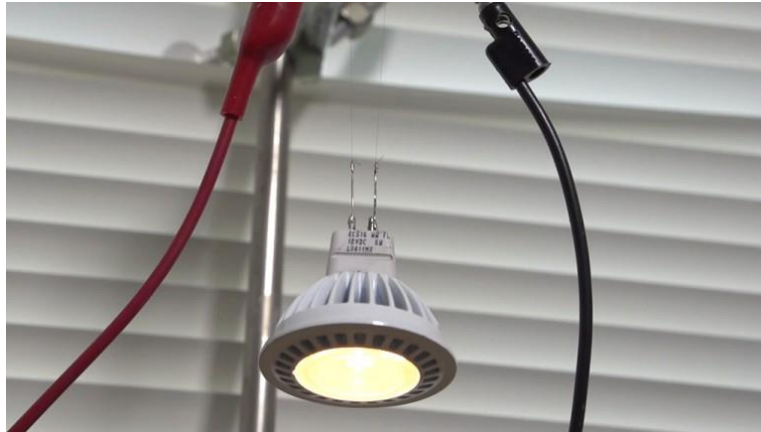
Kuva 4.3. Hiilinojohteilla sytytetty LED-lamppu. (Rice University News, 2013)
