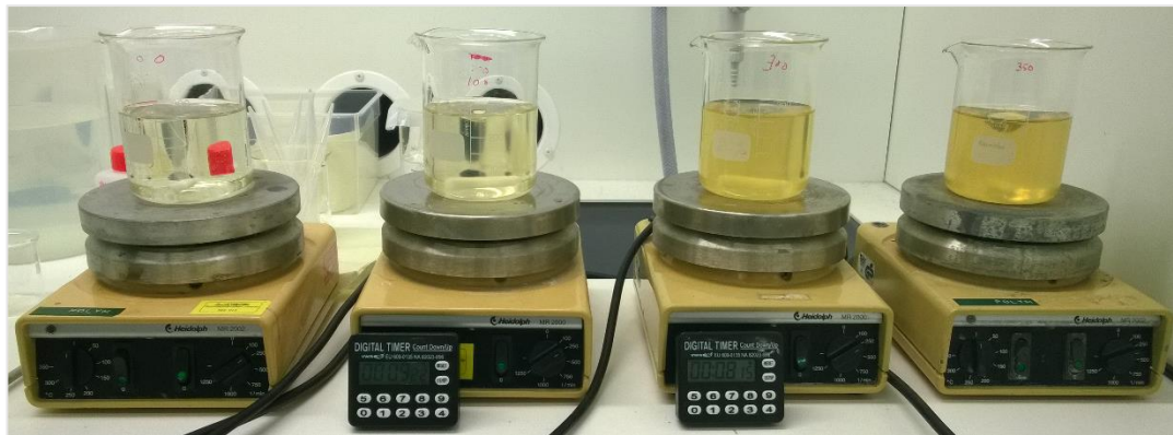
Kuva 6. Saostuskokeiden koejärjestelyt. Kuvassa MBR-permeaatin saostetut näytteet (0, 100, 300 ja 350 mg/L).
